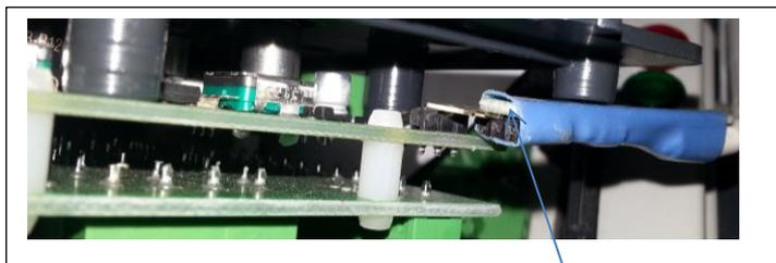
Controllare l'orientamento del connettore ,facendo attenzione ad eseguire un inserimento come in figura.
